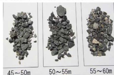
削孔スライム状況：砂岩（ファンカーテン部）
