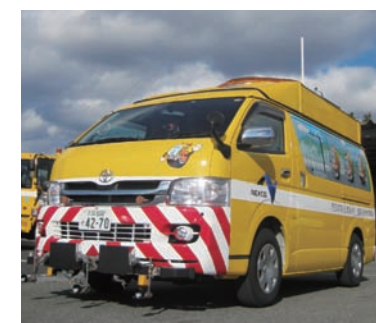
道路施設電波測定車
