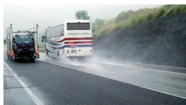
高機能舗装(右は従来の舗装)
