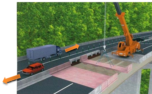
床版取替え工事のイメージ
