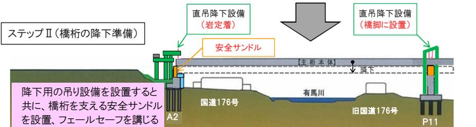
※国道176号解放時(昼間)には、サイドストッパー及びワイヤーで桁を橋脚・橋台と固定
