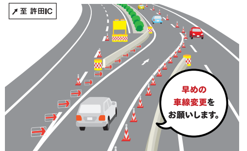
上下線4車線を2車線(対面通行)とし、床版の取り替えを行います。 ※床版の全面取り替えと舗装が完成するまで工事箇所は通行できません。 ※工事の期間は、天候などの影響により変更する場合があります。
