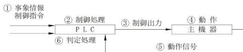
図 2-6-1 自己診断の処理フロー
