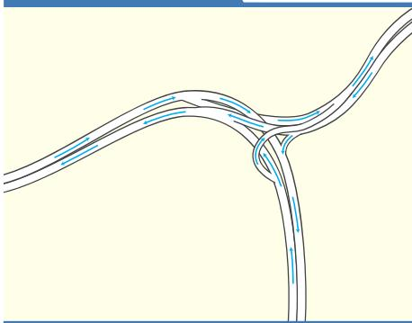
Y型と呼ばれるJCTには、直結Y型と準直結Y型の2種類があります。直結Y型は、接続する道路の交通量が比較的多く、交通量の差が小さい場合に採用されます。準直結Y型は、一方の道路の交通量が相対的に大きい場合に採用されることが多いJCTです。
