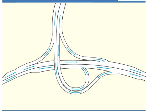
一般的にインターチェンジに多く採用される形式です。連絡道路のぐるっと回る特徴から、トランペット型と呼ばれます。
