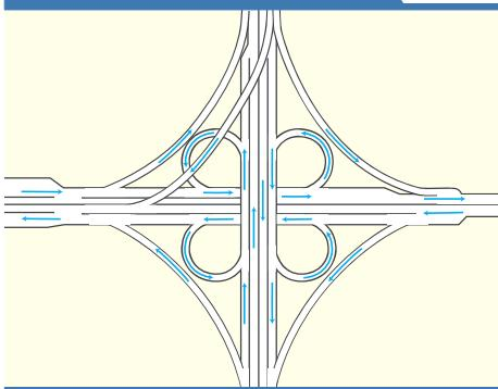
内側に円が4つある形からクローバー型と呼ばれます。急峻な地形の多い日本で採用されることは珍しく、クローバー型を改良した形式が多く用いられます。
