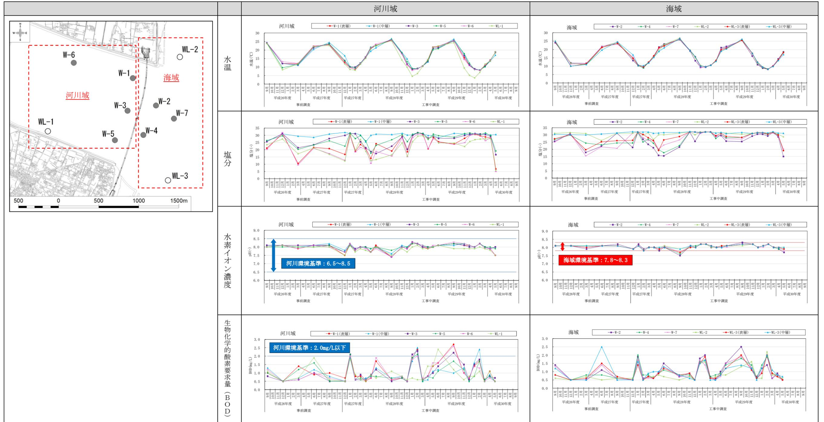
表 3.3-2 定期水質調査 計測結果 (化学的酸素要求量、溶存酸素量、浮遊物質量、大腸菌群数、n-ヘキサン抽出物質)
