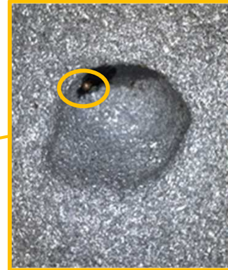
二次孔食深部の残存さび (素地調整後) 4)
