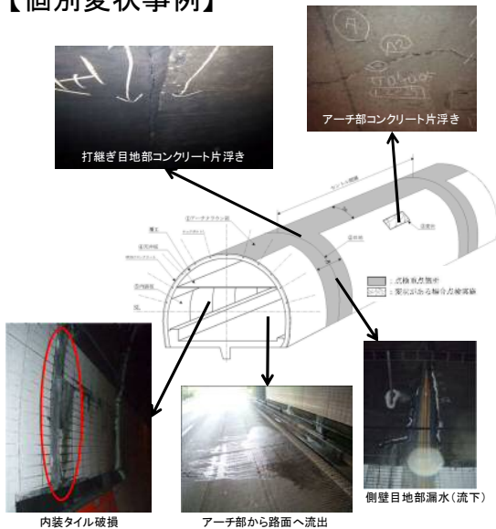
図 2.2.19 詳細点検 B 及び C の概要と個別変状例
