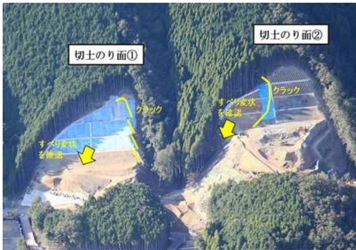
要因：地すべり箇所を調査した結果、滑動した地すべり面の下にも不安定な地質の層が堆積していることが確認された。
