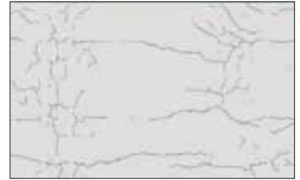
ひび割れ展開図作成イメージ
