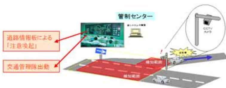
カメラ映像を用いた逆走検知のイメージ
