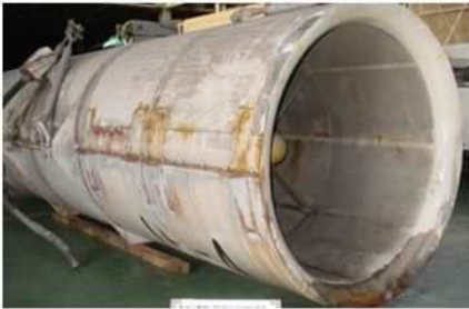
《トンネルジェットファン(補修前)》
