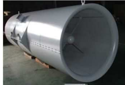
《トンネルジェットファン(補修後)》
