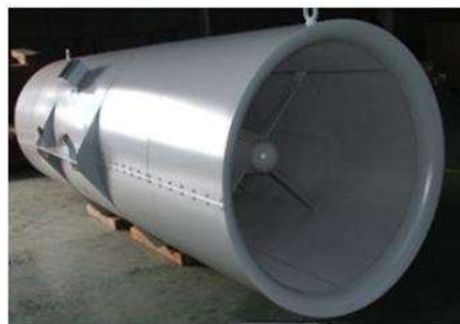
《トンネルジェットファン（補修後）》
