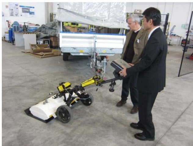
海外の地中レーダ技術の導入支援の様子 海外の地中レーダ技術を日本国内の道路構造物 点検に役立てるため、技術導入支援を実施
