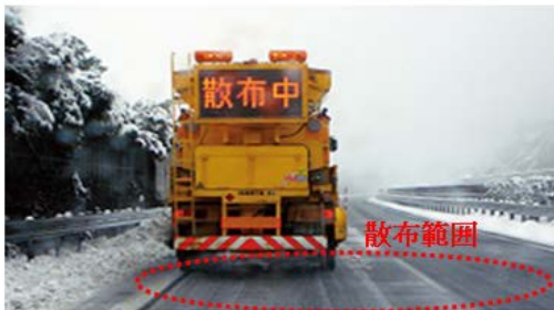
凍結防止剤散布作業(湿塩散布車)
