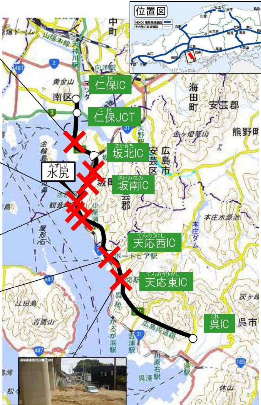
・土石流による道路崩壊 崩落は、約25,000m 3 (幅80m×長さ400m)
