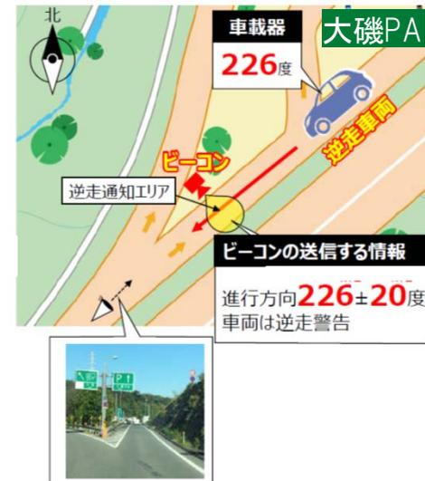
車載器が自車の進行方位を計測し、ビーコンから受信した情報にそった通知を逆走ドライバーへ行う
