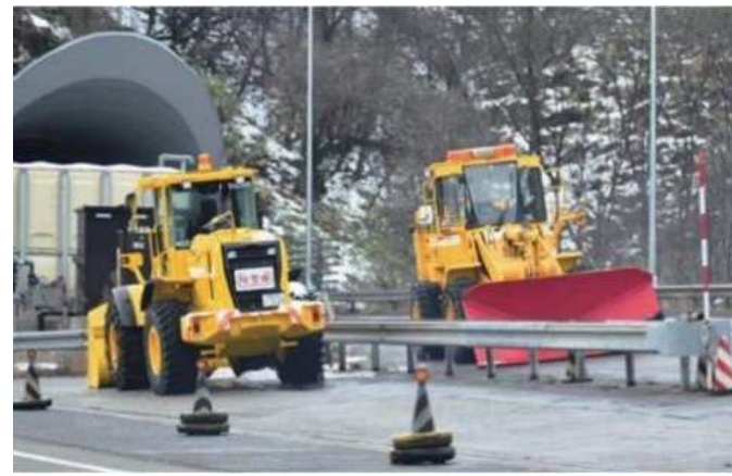
立往生発生時の救出用車両（トラクター・ショベル）の事前配備状況 北陸自動車道 木之本IC～敦賀JCT 高窪トンネル付近
