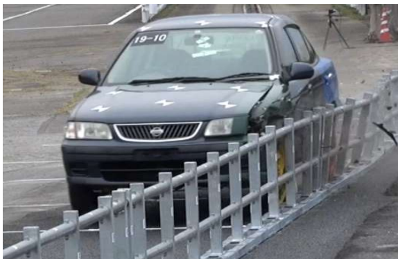
センターパイプ小型車衝突実験状況
