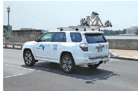
NWU社保有技術道路橋床版点検システム (赤外線・高解像度カメラシステム)
