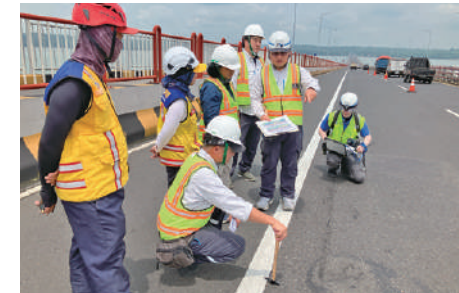
インドネシアで赤外線点検技術が適用できることを実証 (現地政府職員への実演状況)
