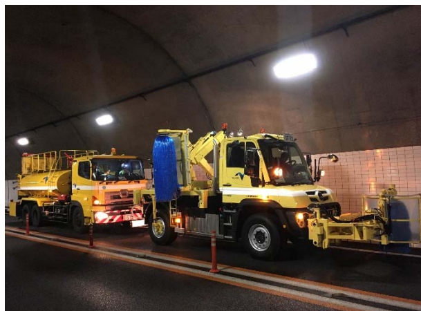
トンネル側壁清掃(イメージ)
