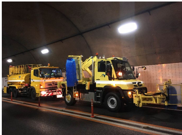
トンネル側壁清掃(イメージ)
