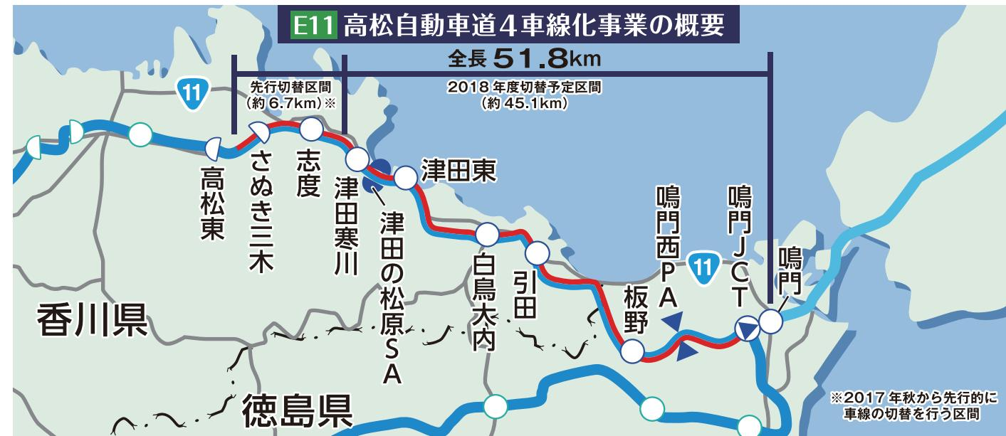
高松自動車道の高松市境から鳴門ICまでの51.8kmは、下図のステップで工事を行ない4車線化していきます。
