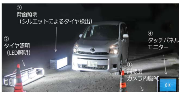
冬用タイヤ自動判別装置の設置イメージ
