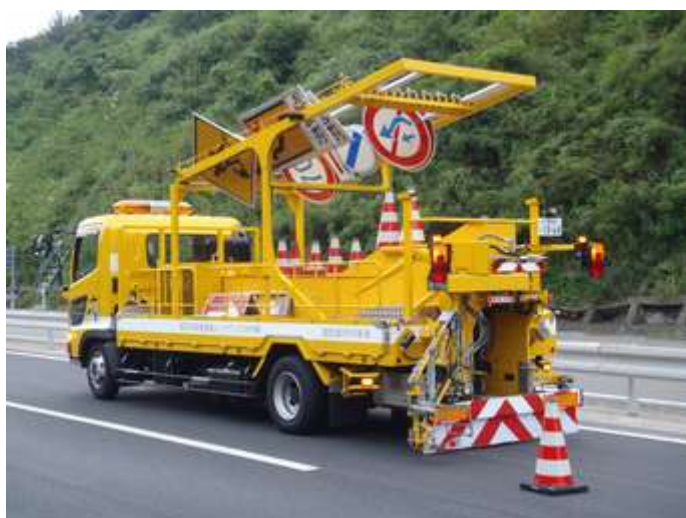
ロボコーンによるラバーコーン設置の様子1
