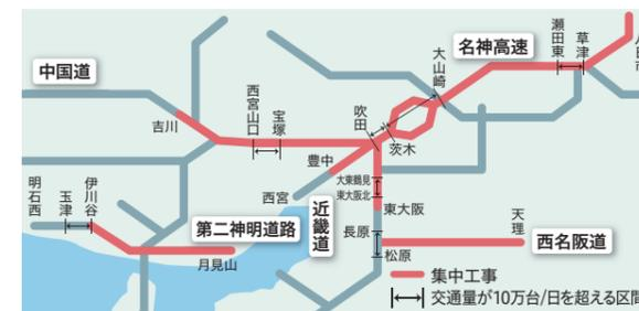
される関西エリアの道路において、道路構造物の点検、清掃、橋梁補修、舗装補修、防護柵改良など年間の工事を短期間に集約(1～2週間程度連続)して実施する「集中工事」を実施しています。集中工事を実施することで交通規制回数を削減し、渋滞の軽減に努めています。
