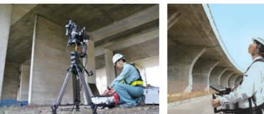
②撮影した画像を分析して、ひび割れやはく離などの損傷を検出
