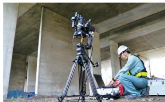
これまでの目視・打音点検に加えて、デジタルカメラでコンクリート表面を撮影し、ひび割れ等の変状を客観的に把握する技術を取り入れています
