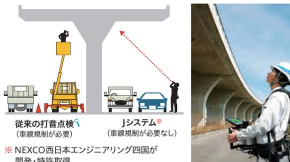
従来の打音点検 (車線規制が必要)      Jシステム (車線規制が必要なし)
