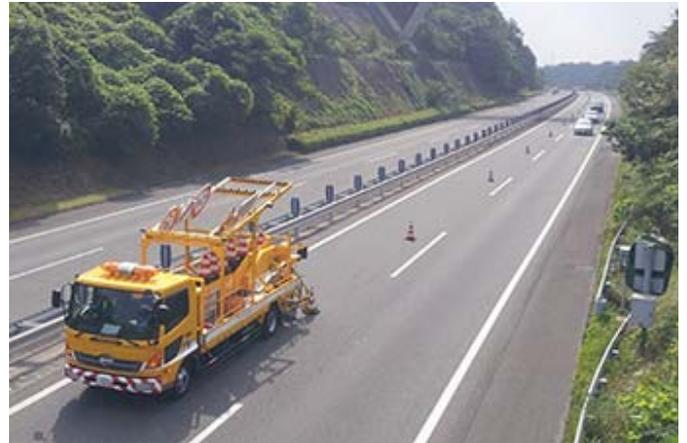
ロボコーンによるラバーコーン設置の様子
