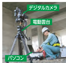
Auto CIMA Systemを使った点検の様子
