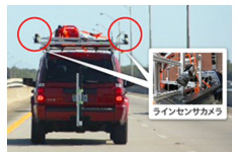
ラインセンサカメラによる コンクリート橋床版の撮影
