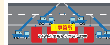
交通規制時間短縮のため、仮設防護柵を迅速に設置・撤去できるロードジッパーシステムを採用
