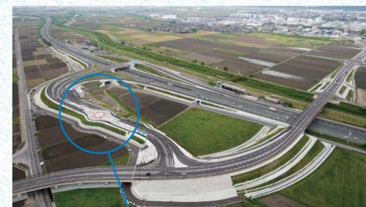
ICの出入り口には「環道型退出路」を採用し、ランプ形状をコンパクト化
