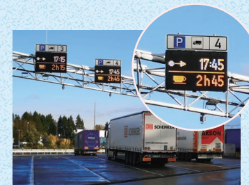
ドイツ(Jura-West)のコラム式駐車場(右の写真は、このマスの出発時間を示す表示)
