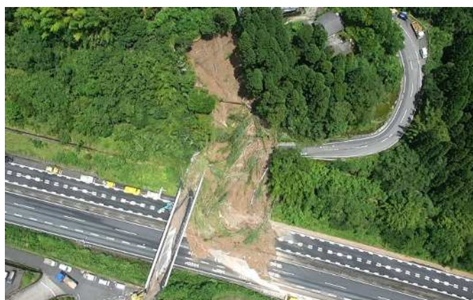
九州自動車道 溝辺鹿兒島空港IC～加治木JCT （のり面土砂崩れ／高速道路の災害復旧）
