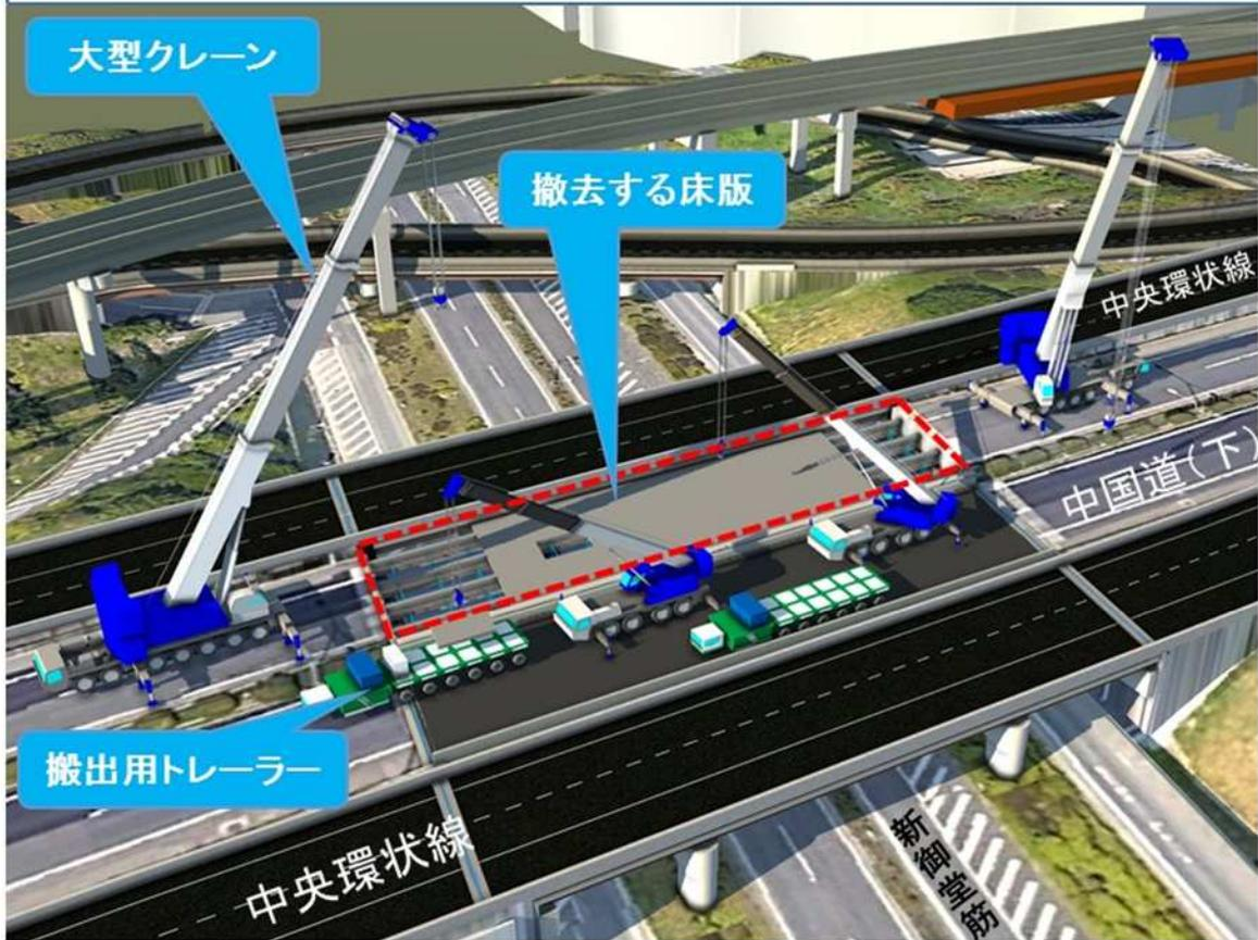
②老朽化した桁の撤去
