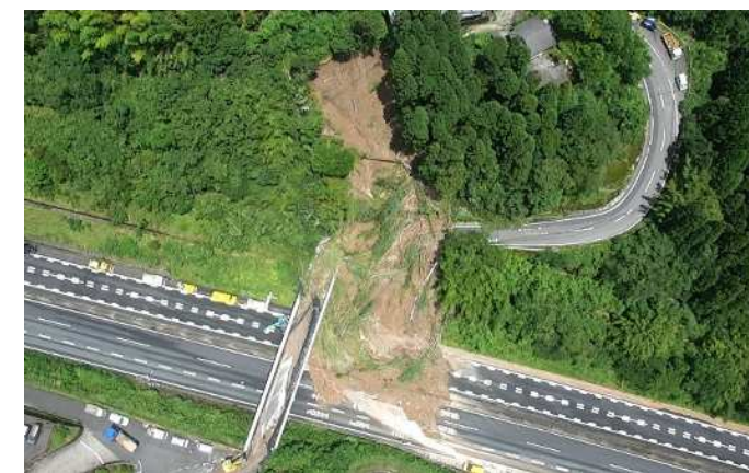
九州自動車道 溝辺鹿兒島空港IC~加治木JCT (のり面土砂崩れ/高速道路の災害復旧)
