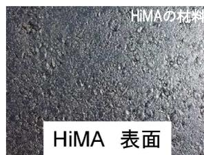
従来の材料と比較して、骨材の最大粒径が小さく、空隙率が小さい
