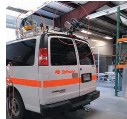
カリフォルニア州政府道路構造物点検車両に採用された赤外線技術： 州政府の技術者に対して技術指導を実施／ Infrared Thermography Mounted on the CALTRANS Highway Inspection Vehicle: Technical training was provided to the CALTRANS engineers
