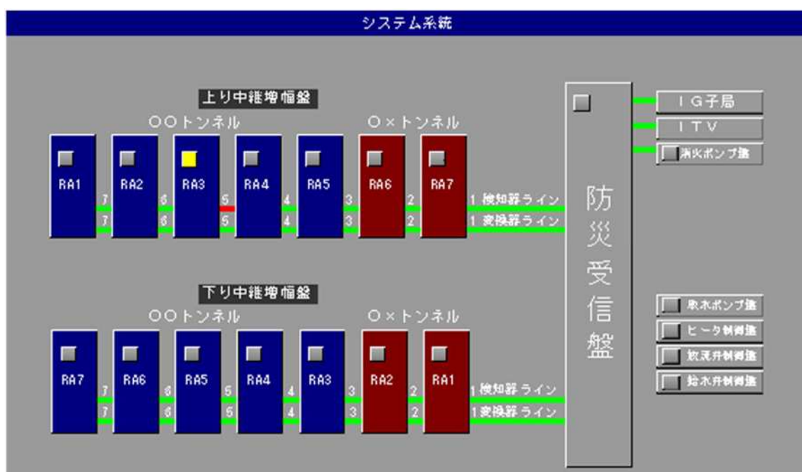
図 2-4-28 システム系統参考図（中継盤無し）
