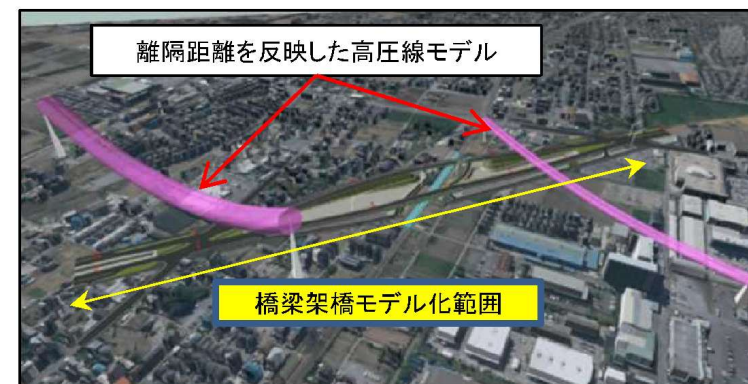
橋梁と架空線の離隔確認
